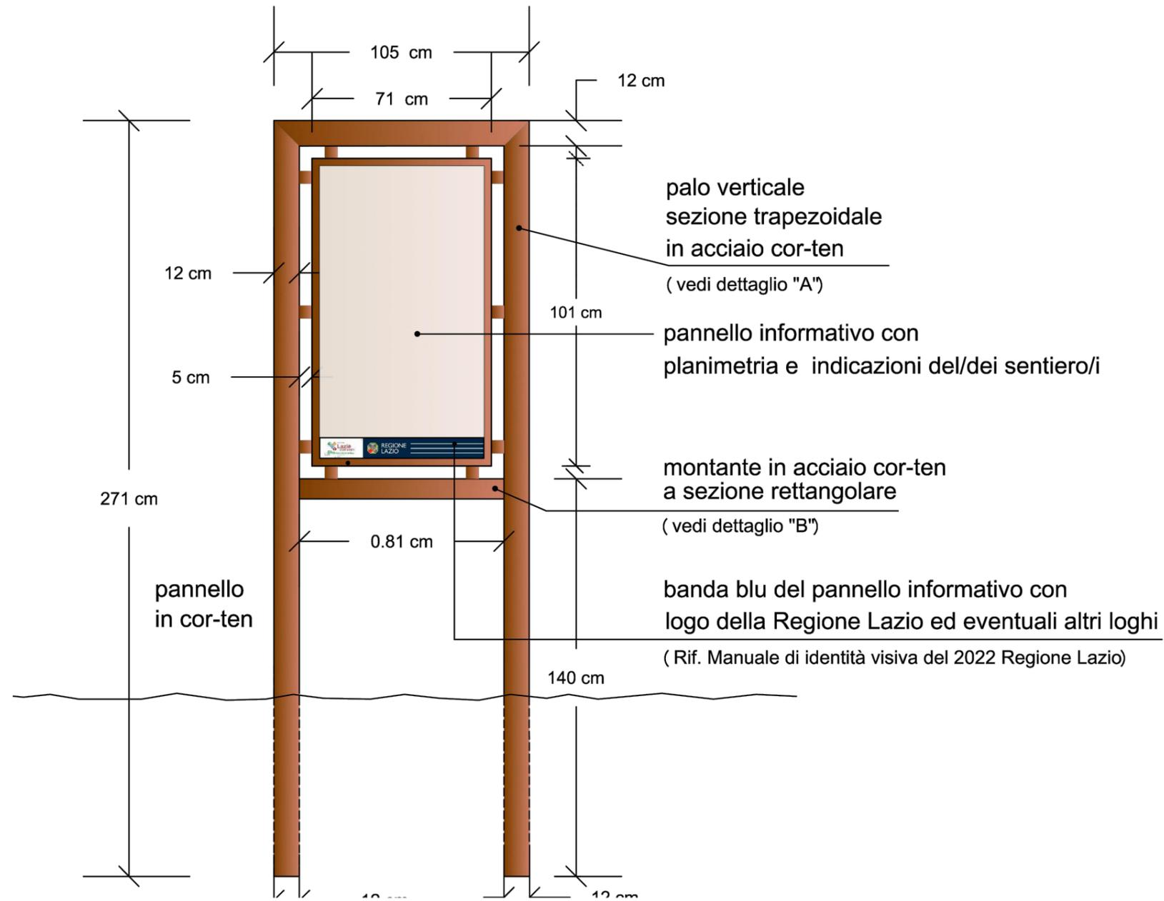
Prospetto/ Sezione, scala 1:20
